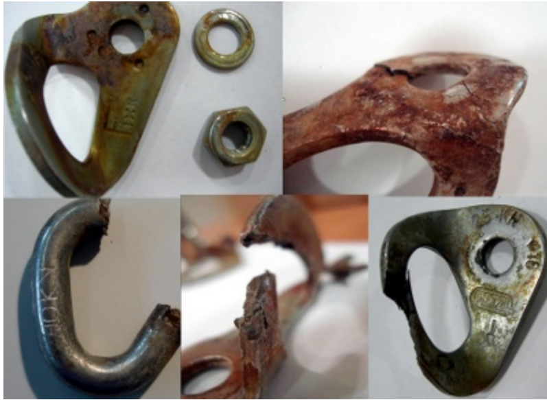
图：保护点在海洋环境下遭受腐蚀
